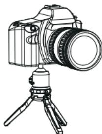
将单反相机安装到迷你三脚架上时，无需任何适配器，只需将单反相机直接安装到球形云台上即可。
