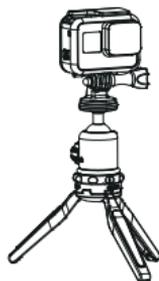
将运动相机安装到三脚架上时，则需通过适配器安装。（适配器需单独购买）
