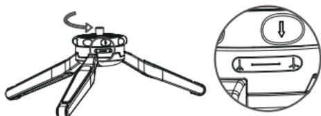
3. 将旋钮朝逆时针旋转，为降低脚架模式。
