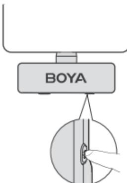
9.双击接收器电源键可开启外放功能，即可直接外放手机音频。
