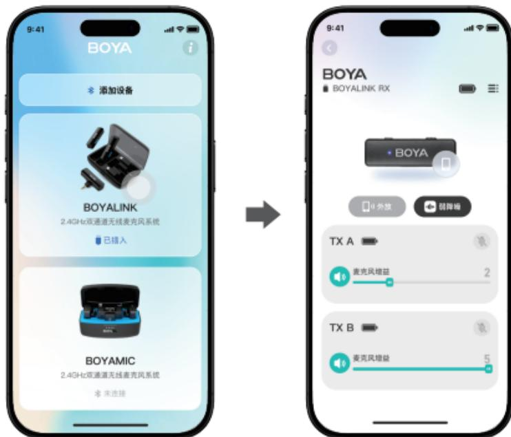
• 点击“外放”，可开启/关闭外放功能。(开启或关闭外放功能时，接收器将重新启动)
