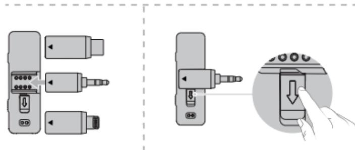
2.选择适配的转接头安装到接收器的凹槽,然后连接至相机、手机、平板、或电脑等设备。
